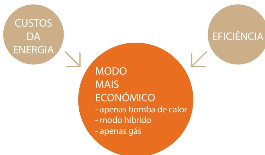
Dependendo da temperatura exterior, dos preços da energia e das necessidades de aquecimento, o sistema Daikin Altherma híbrido escolhe de forma inteligente entre a bomba de calor e/ou a caldeira a gás, permitindo um funcionamento simultâneo, selecionando sempre o modo de funcionamento mais económico.
