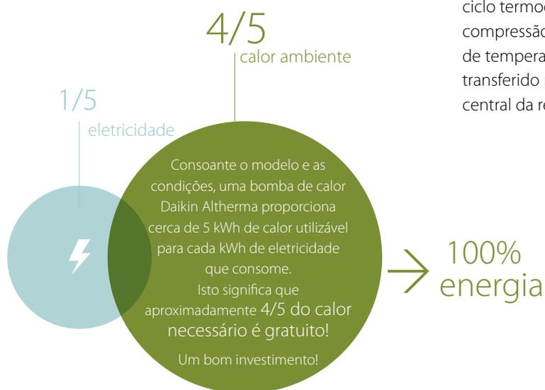
A bomba de calor ar-água Daikin Altherma utiliza uma fonte de energia sustentável: o calor extraído do ar exterior. Num circuito fechado com fluido frigorigéneo, é criado um ciclo termodinâmico através de evaporação, condensação, compressão e expansão. Isto "bombeia" o calor de um nível de temperatura inferior para um superior. O calor obtido é transferido para o sistema de distribuição de aquecimento central da residência através de um permutador de calor.
